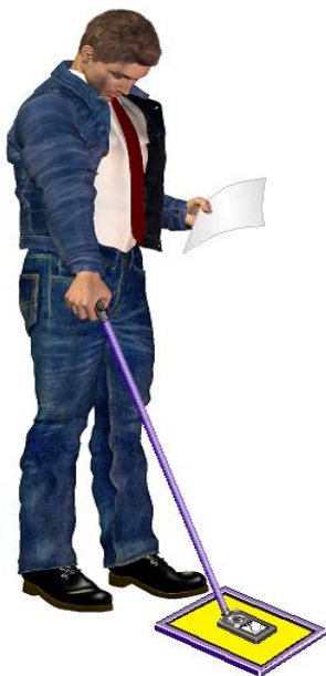
Рис.2.7. Определение количества слоев в рулонной кровле с помощью кровельного дефектоскопа
