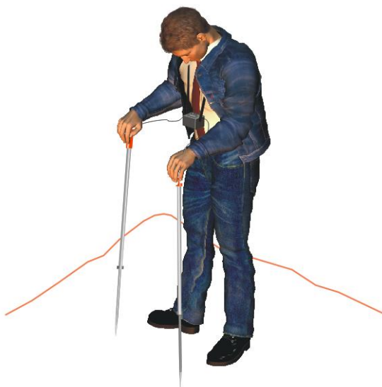
Рис. 2.2. Поиск скрытых протечек в рулонной кровле низковольтным методом
