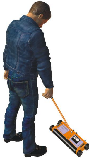
Рис. 2.4. Поиск скрытых протечек в рулонной кровле сканирующим емкостным влагомером
