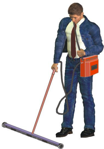
Рис. 2.3. Поиск скрытых протечек в рулонной кровле высоковольтным методом
