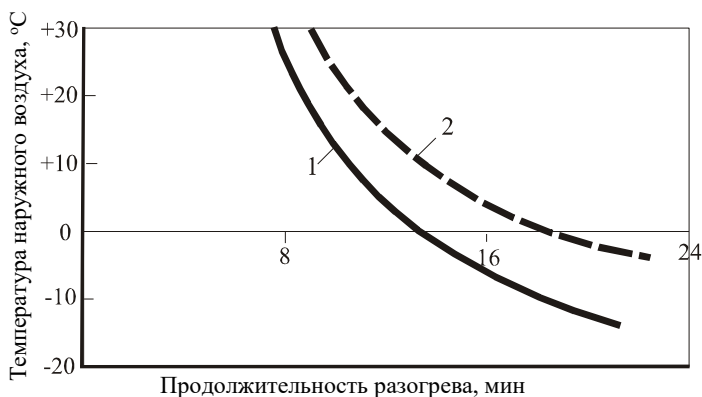
Рис. 3.2. Изменение продолжительности разогрева водоизоляционного ковра в зависимости от погодных условий:
