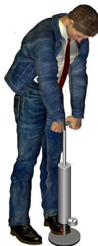
Рис. 2.11. Проверка прочности приклейки рулонных кровельных материалов с помощью пористомера
