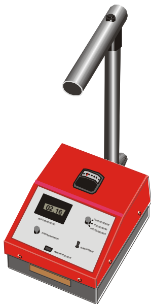
Рис. 2.5. Радиоизотопный влагомер, используемый для выявления скрытых протечек в рулонных кровлях
